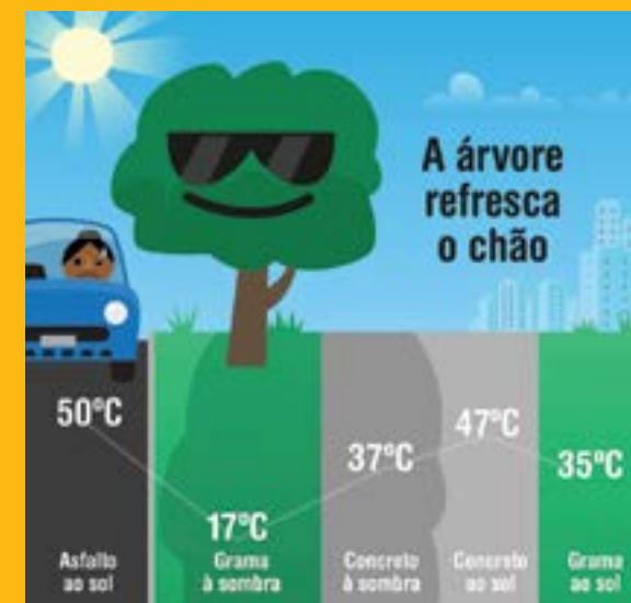
Figura B7.1.1.2 | Comparação entre as temperaturas dos pavimentos
