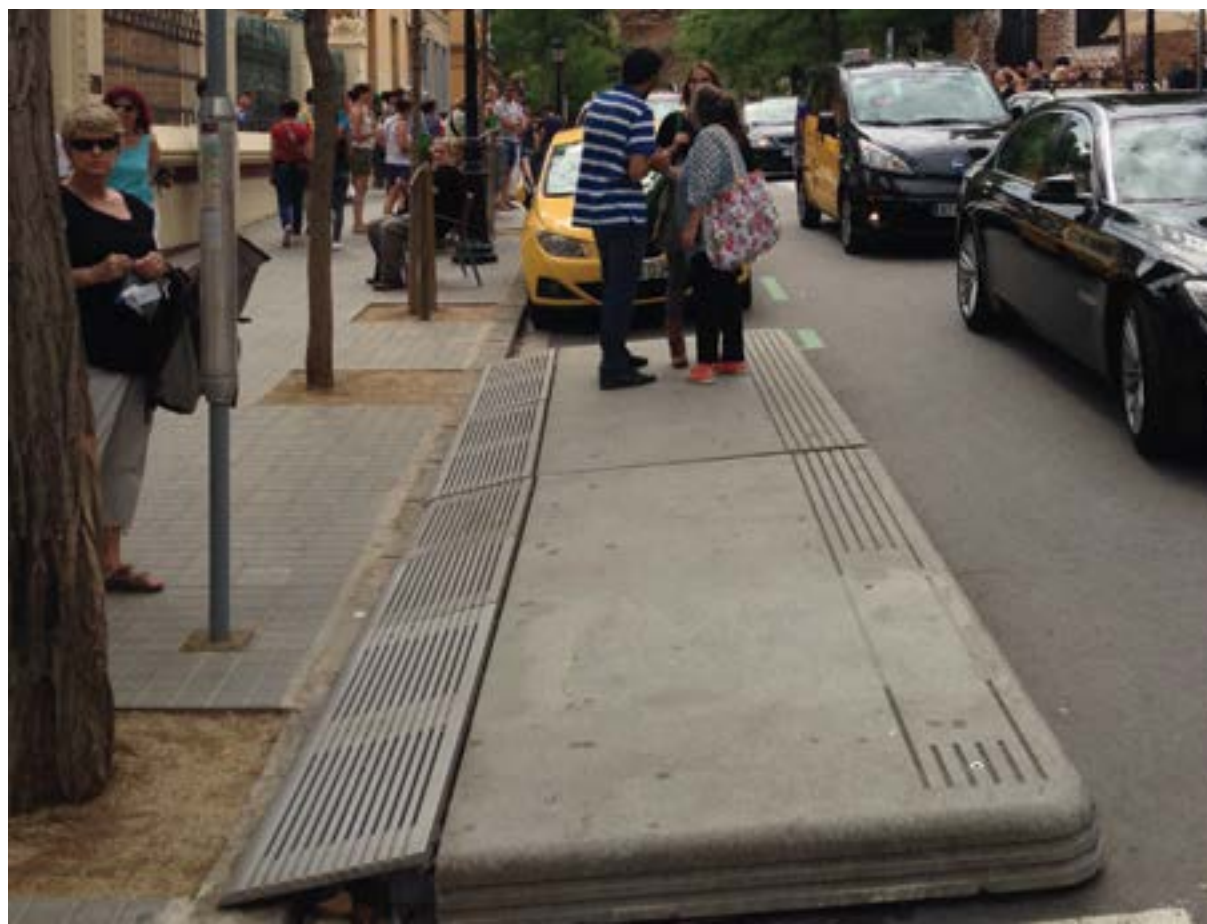
Figura 3.2.2 | Extensão do meio-fio como parada de ônibus
